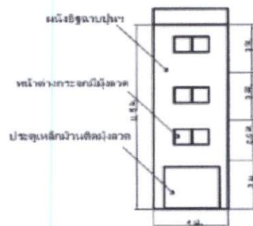
๓. ตัวอย่างแบบแปลนแผนผัง รูปด้านข้าง (ระบุมাত্রาส่วน วัสดุใช้สร้าง)
